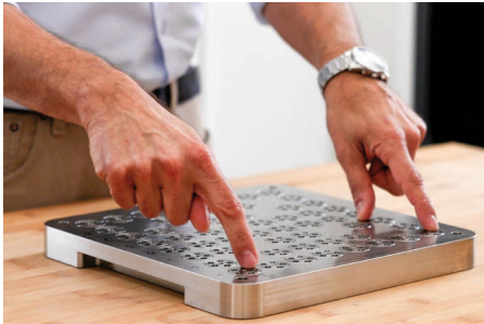
Bild 3a: Eine passgenaue Trägerplatte garantiert höchste Positionsgenauigkeit beim Laserschmelzverfahren.
