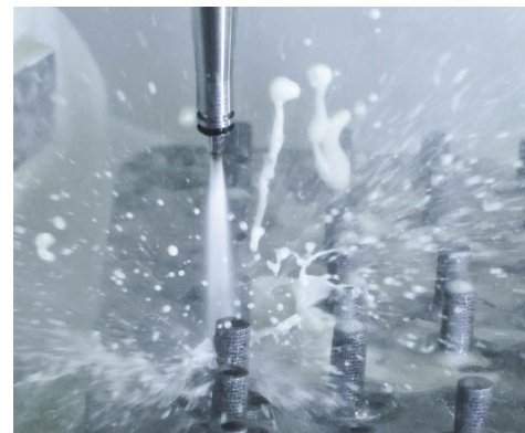
Bild 4: Die hybridgefertigten medizintechnischen Komponenten benötigen nur eine minimale Anzahl von Nachbearbeitungsschritten. Die Bearbeitung der Teile in einer Aufspannung ist kraftschlüssig und äußerst rationell.
