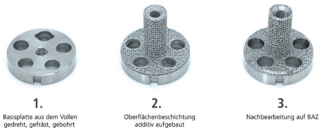
Bild 2a: Produktionsverlauf: 1. Zerspanende Basisplatte | 2. Additiv aufgebaute Hohlzapfen und Implantatoberfläche zur Osseointegration | 3. Profilschichten und Gewindefräsen auf der WZM DMP70
