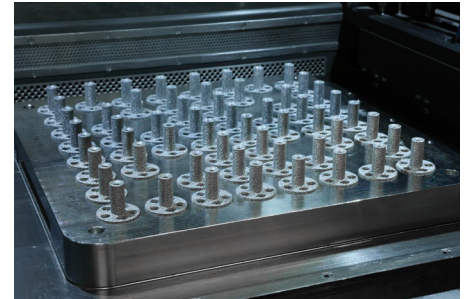
Bild 3c: In 10 h 16 min erfolgt der Aufbau des Hohlzapfens und der Implantatoberfläche im Laserschmelzverfahren.
