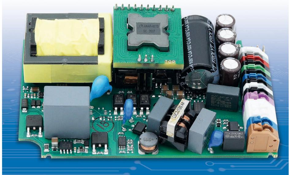
**Bild 4: 4-Kanal LED-Treiber Single-Stage Resonanzwandler (ohne Zwischenkreis-Elko)**
