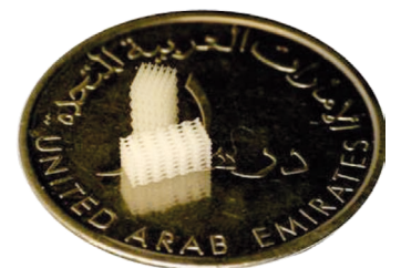
Mit dem microArch S240 von Boston Micro Fabrication hergestellte Metamaterial-Strukturen, die Merkmale in der Größenordnung von Zehntel-µm enthalten.
