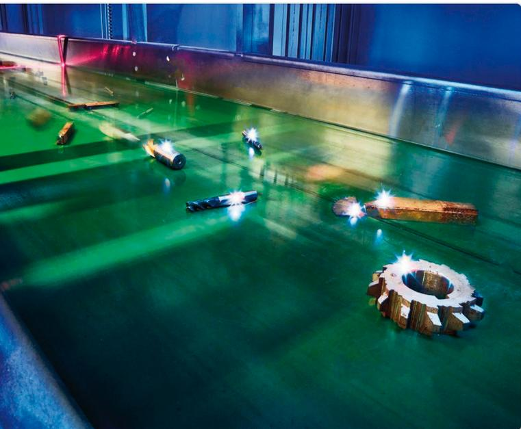
**Die Laser-induced Breakdown Spectroscopy LIBS detektiert wertvolle Legierungen in Metallschrott, den Roboter sortenrein trennen. Das Verfahren schafft die Grundlage für geschlossene Stoffkreisläufe ohne Downcycling. © Fraunhofer ILT, Aachen/Volker Lannert**
