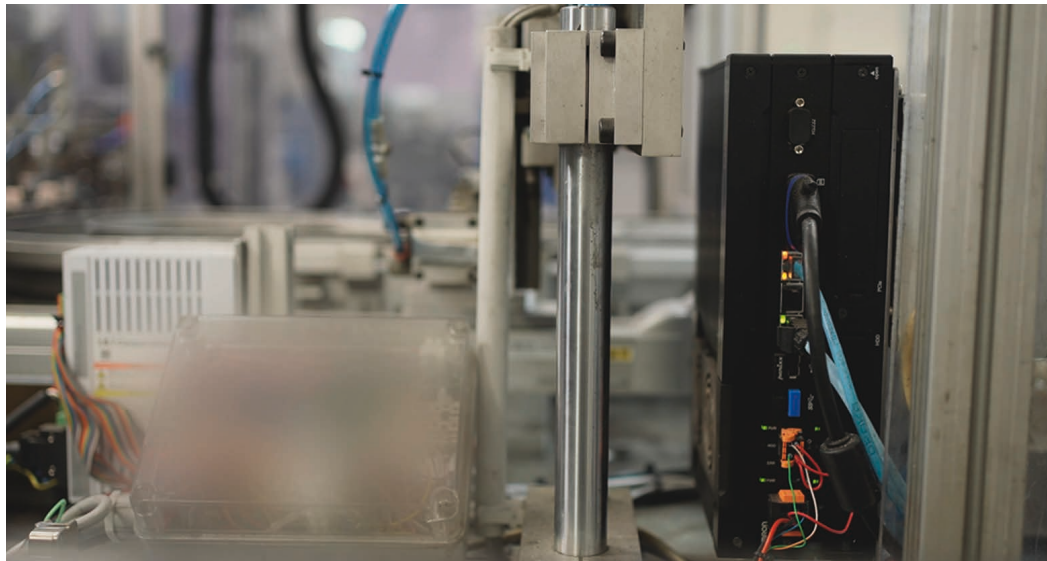
Bild 4: Einer der größten Vorteile des KI-basierten Controllers ist, dass er sich mit der Maschine synchronisieren und Daten mit Millisekunden-Genauigkeit abfangen kann. © OMRON
