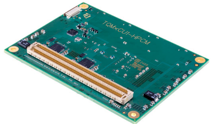
Beim neuen COM-HPC Mini Standard sorgt ein 400-Pin High-Speed-Steckverbinder für Zukunftssicherheit und hohe Integrationsdichte. © TQ-Systems GmbH
