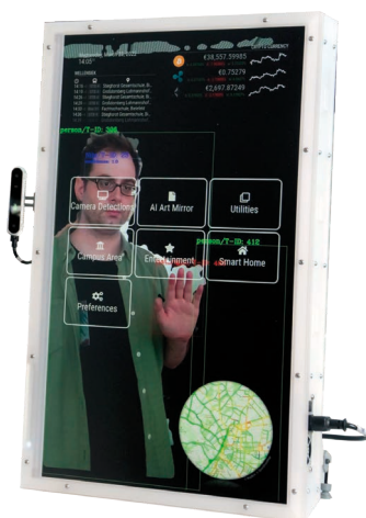
Bild 2: Smart mirror Demonstrator als Teil der Smart Home Anwendung in VEDLIoT
