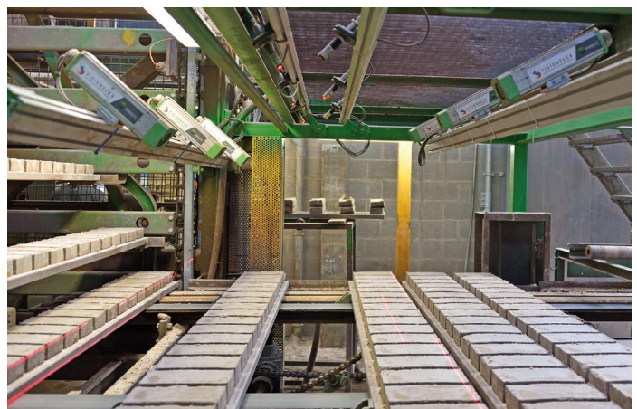
Bild 2: Bei der Ziegelvermessung in staubiger Umgebung schützen die Gehäuse Kameras und Laser
