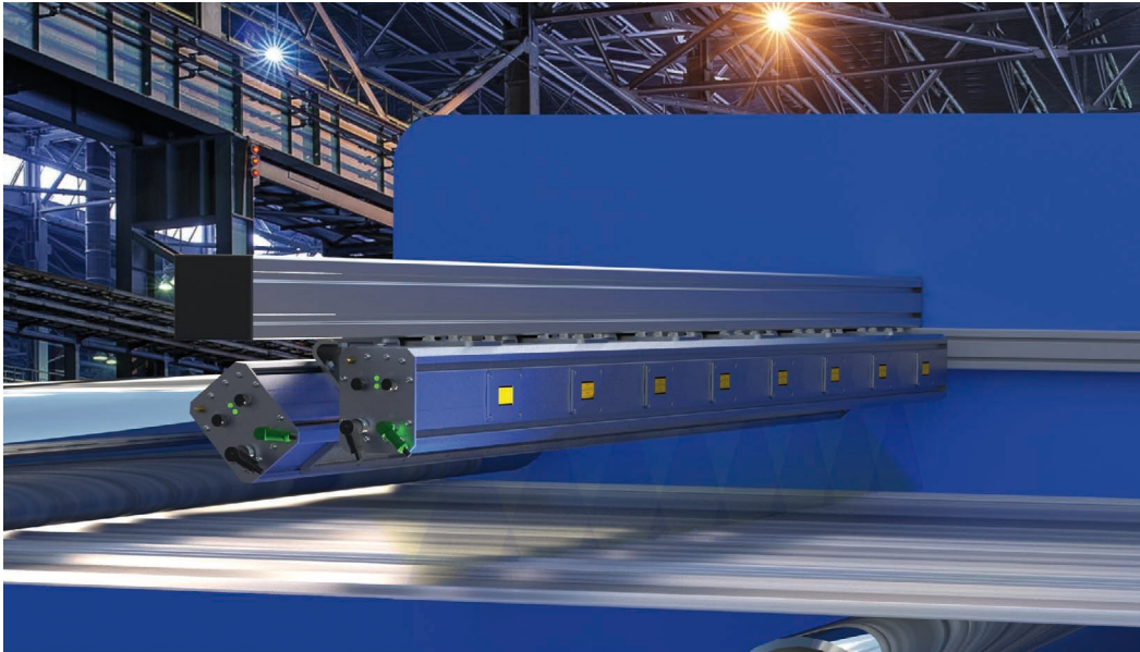
Bild 2: Planheitsmessung in einer Kunststofffolien-Produktion
