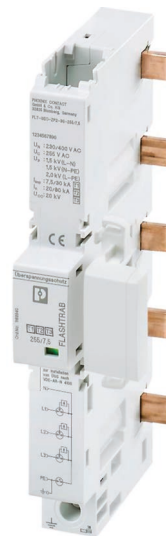
Bild 3: Der Phoenix Contact 1168940-FLT-SEC-ZP2-3S-255-7.5 ist ein Ableiter vom Typ 1 für maximal 20 kA und passt herstellerunabhängig in jeden Zählerschrank dank schmaler Baubreite von nur 27 mm
