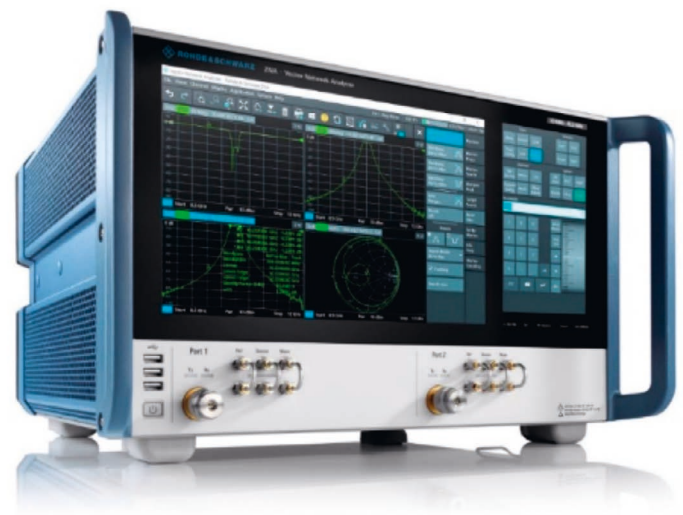
Bild 9: Die Messung wurde mit einem Rohde & Schwarz ZNA43 2-Port-Vektor-Netzwerkanalysator durchgeführt
