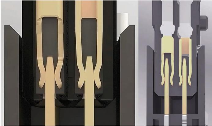
**Bild 5: doppelseitiger Federkontakt ohne (links) und mit Schockeinwirkung (rechts)**
