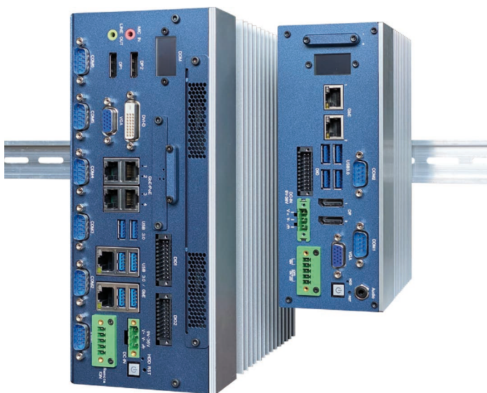
Bild 5: Der lüfterlose Eagle-Eyes AIMD7 von EFCO (rechts im Bild) ist für den Einbau im Schaltschrank auf der Hutschiene ausgelegt und verfügt über einen DC-Weitbereichseingang. Links sein großer Bruder, der AIHD, der neben deutlich mehr Schnittstellen vor allem mit einer höheren Rechenleistung aufwartet. © EFCO
