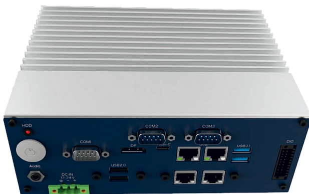
Bild 7: Häufig läuft auf dem ursprünglichen PC einer Bestandsanlage ein veraltetes Betriebssystem, das upzudaten sich niemand traut, weil unklar ist, ob die Maschine anschließend problemlos funktionieren wird. Abhilfe schafft der U3-D80-Compact IPC von EFCO, der einfach vor das bestehende System geschaltet wird. © EFCO
