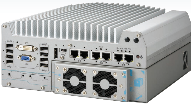
Edge KI-Computer mit Intel 13./12. Gen. CPU für KI-Inspektion, Roboterführung und autonome Maschinen © Neousys Technology
