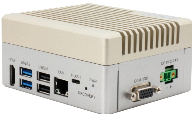
Hochkompakte Edge Computer mit KI-Beschleunigern wie NVIDIA Jetson Orin (BOXER-8651AI) verbessern die Bilderkennung und Autonomie in Produktionsstätten © AAEON Inc.
