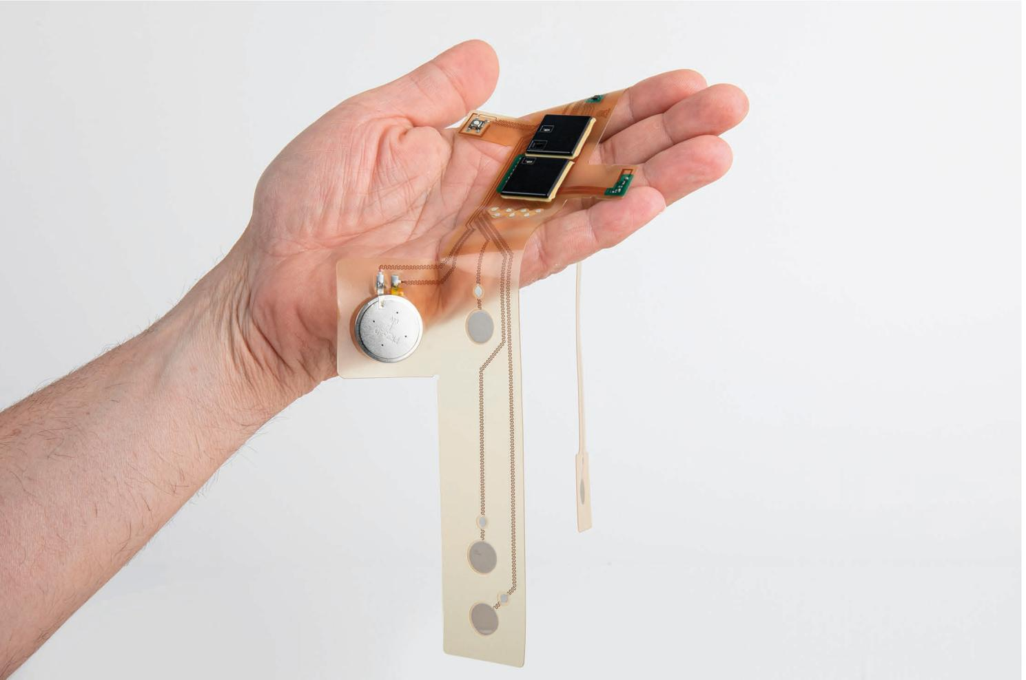
**Bild 1: Dehnbare Leiterplatte mit integrierter Elektronik und gedruckten Elektroden – ein ausgesprochen nachgiebiges und biokompatibles Substrat für Smart Patches. (Bilder © Würth Elektronik Circuit Board Technology)**
