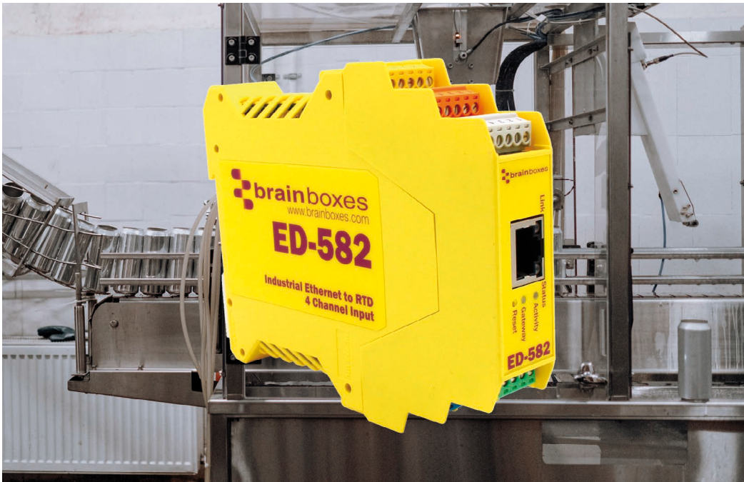
Bild 2: Industrielles Remote-I/O-Modul in Anreih-Gehäuse-Bauform für DIN-Hutschiene, Beispiel 4-Kanal RTD-Eingänge
