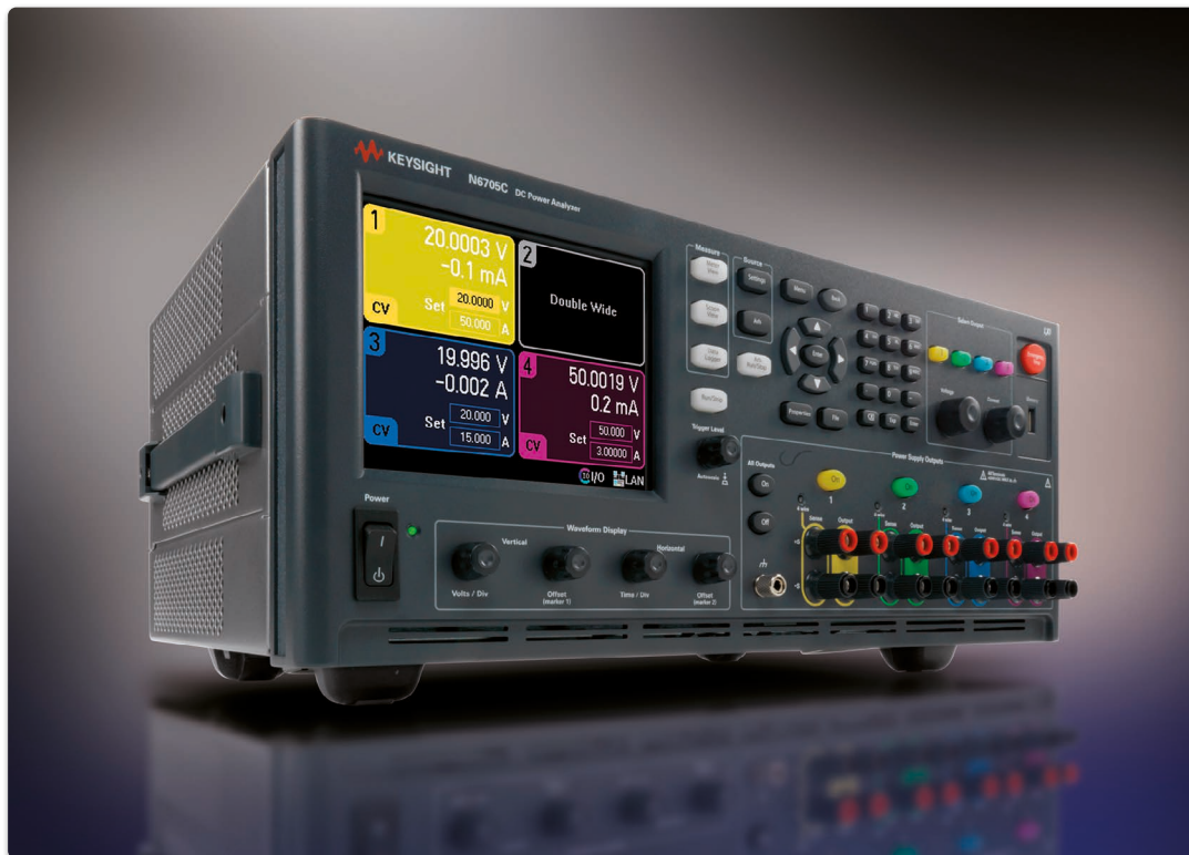
Bild 4: DC-Leistungsanalysator Keysight N6705C mit vier Slots für verschiedene Stromversorgungs-, Last- und SMU-Module
