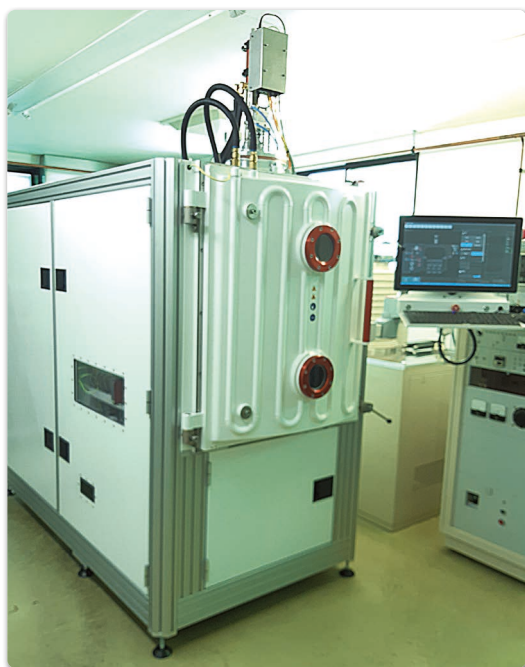
Die Beschichtungsanlage BAK640 ist eine Spezialanfertigung der Firma Coaters Paradise Schweiz
