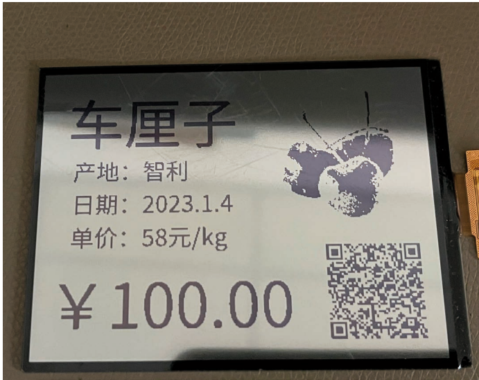
Bild 4: Reflektives TFT-Display, partielles Licht von vorne
