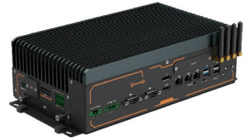
Embedded PC mit Intel Core i5-1135G7, Hailo-8 VPU für KI-Anwendungen und Edge Computing mit 8 GB und 128 GB SSD
