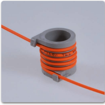
Bild 7: Mandrel Wrap beseitigt die Moden höherer Ordnung bei Multimode-Dämpfungsmessungen unter Verwendung einer LED-Lichtquelle
