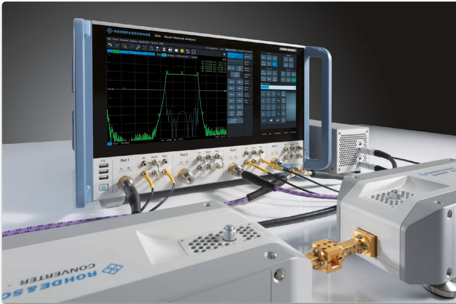
Bild 1: Mit dem R&S ZNA VNA lassen sich Messungen im THz-Bereich unter Einsatz von Millimeterwellenkonvertern ebenso komfortabel konfigurieren wie in niedrigeren Frequenzbereichen (links). Das integrierte MPI TS150-THz Sondensystem mit Mikroskop ist mit dem R&S ZNA für Messungen auf Wafer-Ebene bis 330 GHz konfiguriert. Hohlleitersonden von GGB Industries Inc. sind direkt am Ausgang der R&S ZC330 Millimeterwellenkonverter montiert (rechts)
