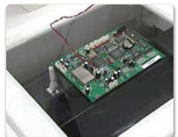
Bild 9: EMI-Störungsabtastung. Über flexible Drähte werden Proben angenähert
