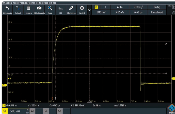
Bild 7: Referenzmessung mit 1-kOhm-Pullups ohne weitere Änderungen der verwendeten FeatherWing Hardware (= 46 ns Anstiegszeit)
