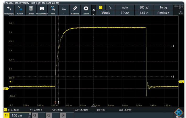
Bild 8: Referenzmessung mit 1-kOhm-Pullups + Multilayer-SMT-Ferrit + TVS-Diodenarray + 20 cm Kabellitzen (= 46 ns Anstiegszeit)
