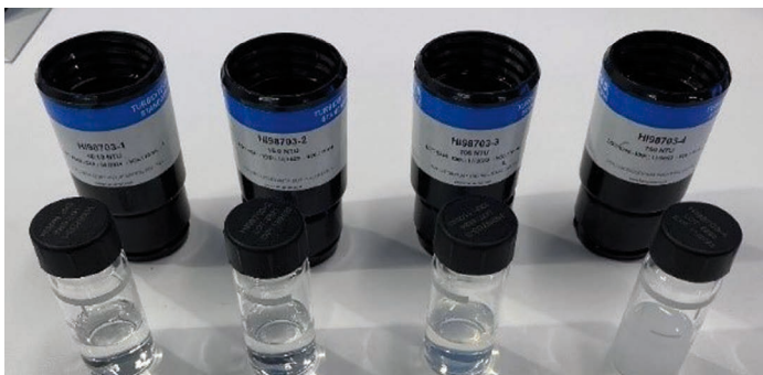
Bild 8: Unterschiedliche Kalibrierstandards für die Trübheitsmessung
