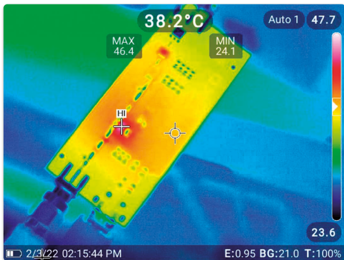
Bild 7: Impression vom Wärme-Management, Verhalten bei einer HF-Eingangleistung von 10 dBm
