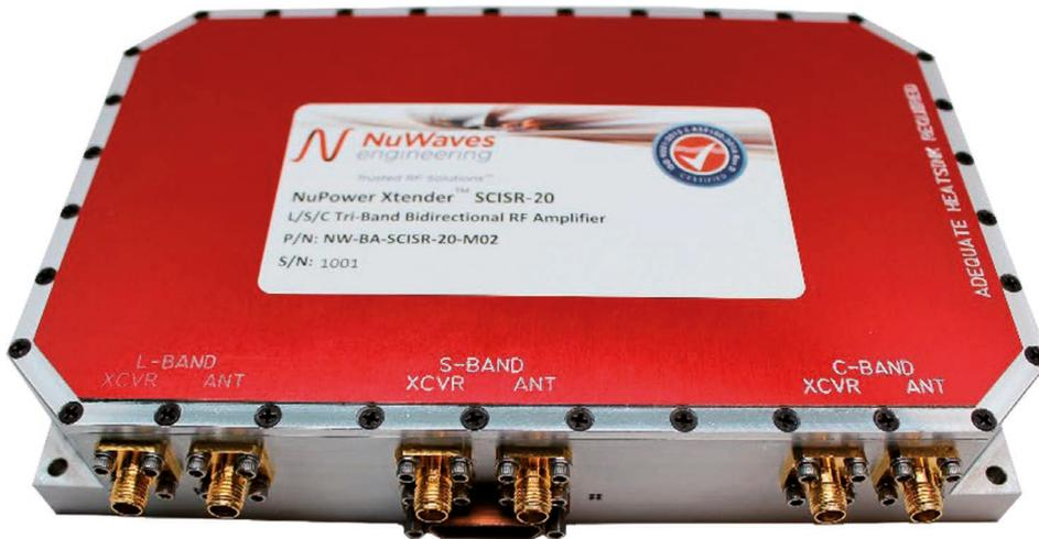
**Der NuPower Xtender SCISR-20 Triband Bidirectional Amplifier nutzt die extreme Leistungsdichte und Frequenzflexibilität von GaN, um 20 W Psat im L/S-Band und 10 W Psat im C-Band zu liefern, dies bei einem Formfaktor von nur 7,25 x 4,5 x 1,38 Zoll**
