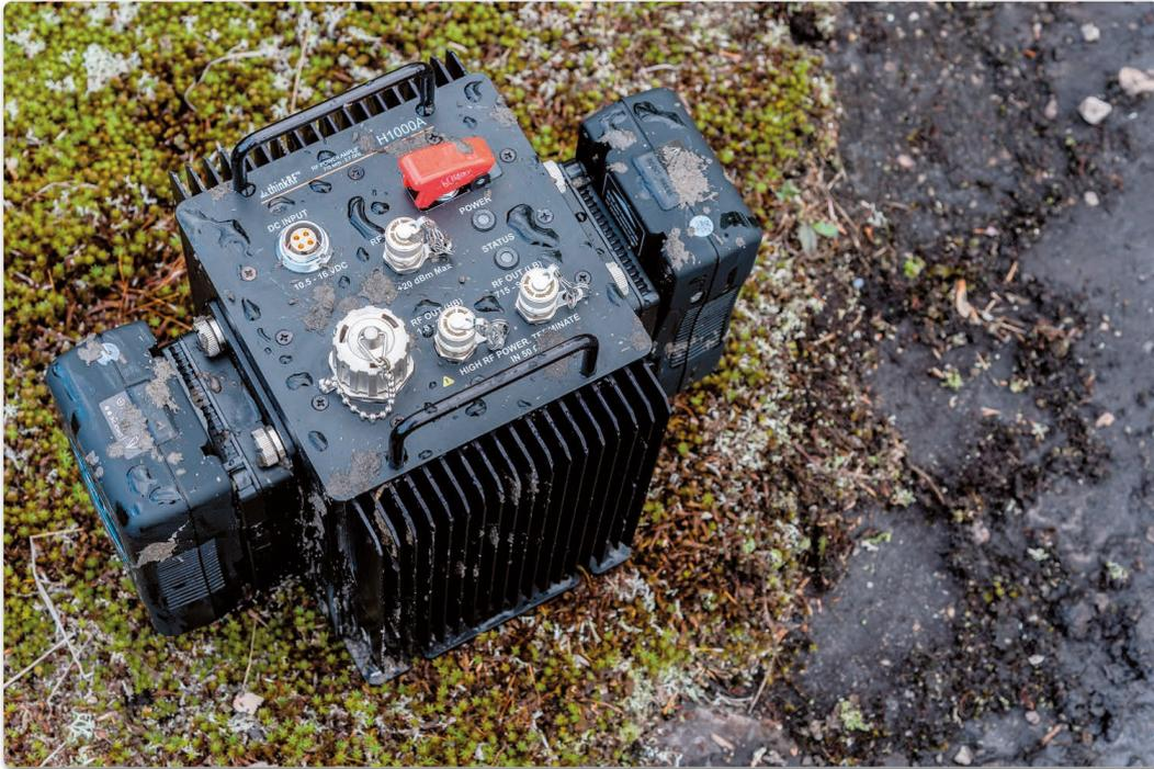
**Der thinkRF H1000A HF-Leistungsverstärker wurde für zuverlässigen 12-V-Betrieb in kritischen Anwendungen entwickelt. Intelligent, robust, kompakt, leise und vernetzt bietet dieser zellulare Multiband-Verstärker die gleichzeitige Abdeckung der Bänder zwischen 715 MHz und 2,7 GHz**
