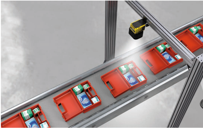
Bildverarbeitungssysteme können unter anderem die Vollständigkeit von Waren in vielen Bereichen überprüfen.
