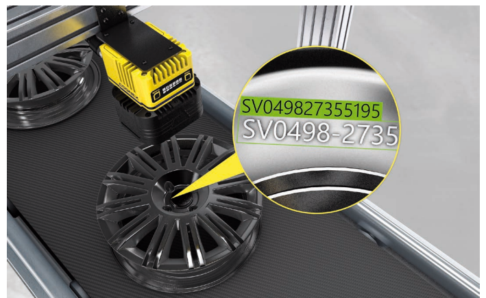
Bildverarbeitungs-Tools, die auf Grundlage von KI funktionieren, vereinfachen Anwendungen wie das Lesen von Klarschrift auf herausfordernden Hintergründen.
