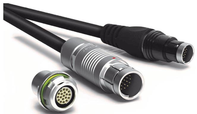
**Da medizinische Komponenten häufig gereinigt werden müssen und die dafür verwendeten Reinigungsmittel meist sehr aggressiv sind, ist eine spezielle Beschichtung der Steckverbinder notwendig. Besonders gut geeignet sind Steckverbinder aus Messing mit einer chromierten Oberfläche, um Beschädigungen zu vermeiden.** © Fischer Connectors
