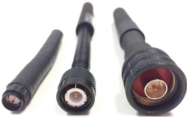
Bild 2: Schwarzverchromte Steckverbinder. Von links: SMA(m), TNC(m), Typ-N(m)
