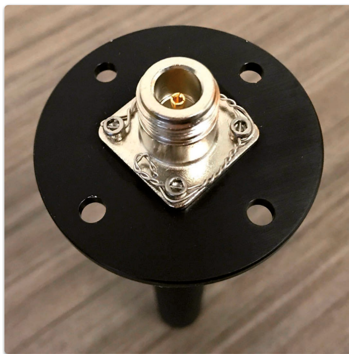
Bild 7: Beispiel für einen Sicherungsdraht zur Befestigung eines HF-Steckers am Antennenmontageflansch für den Einsatz in Umgebungen mit starken Vibrationen
