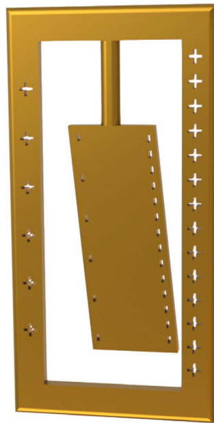
Bild 3: Neigung oder Beschleunigung in die entgegengesetzte Messrichtung
