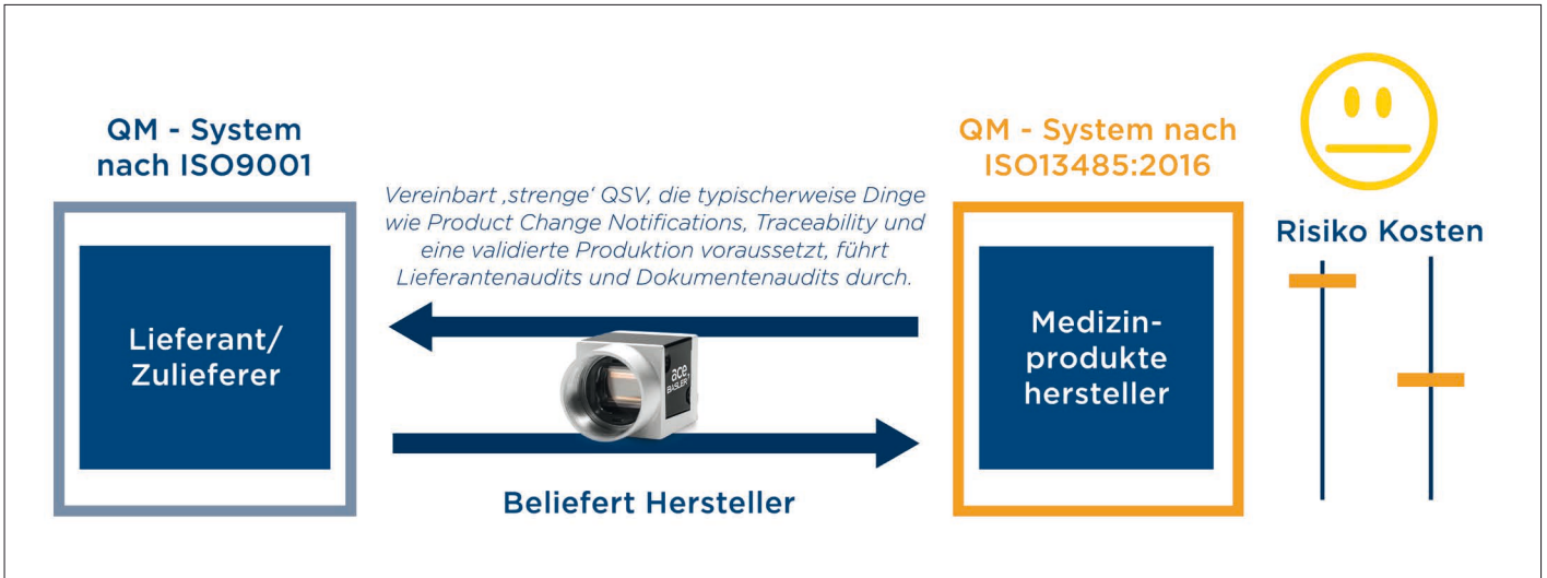
Bild 1: Die Zusammenarbeit mit Lieferanten, die nach ISO9001 arbeiten, birgt geringere Kosten, aber ein höheres Risiko und Komplexität.
