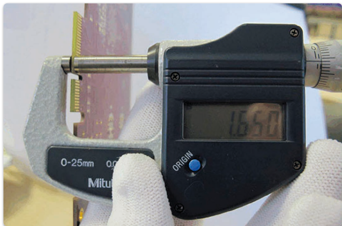
Viele Faktoren wie die Ausgangsmaterialien, die Fertigungsprozesse und das Layout beeinflussen die endgültige Dicke einer Leiterplatte
