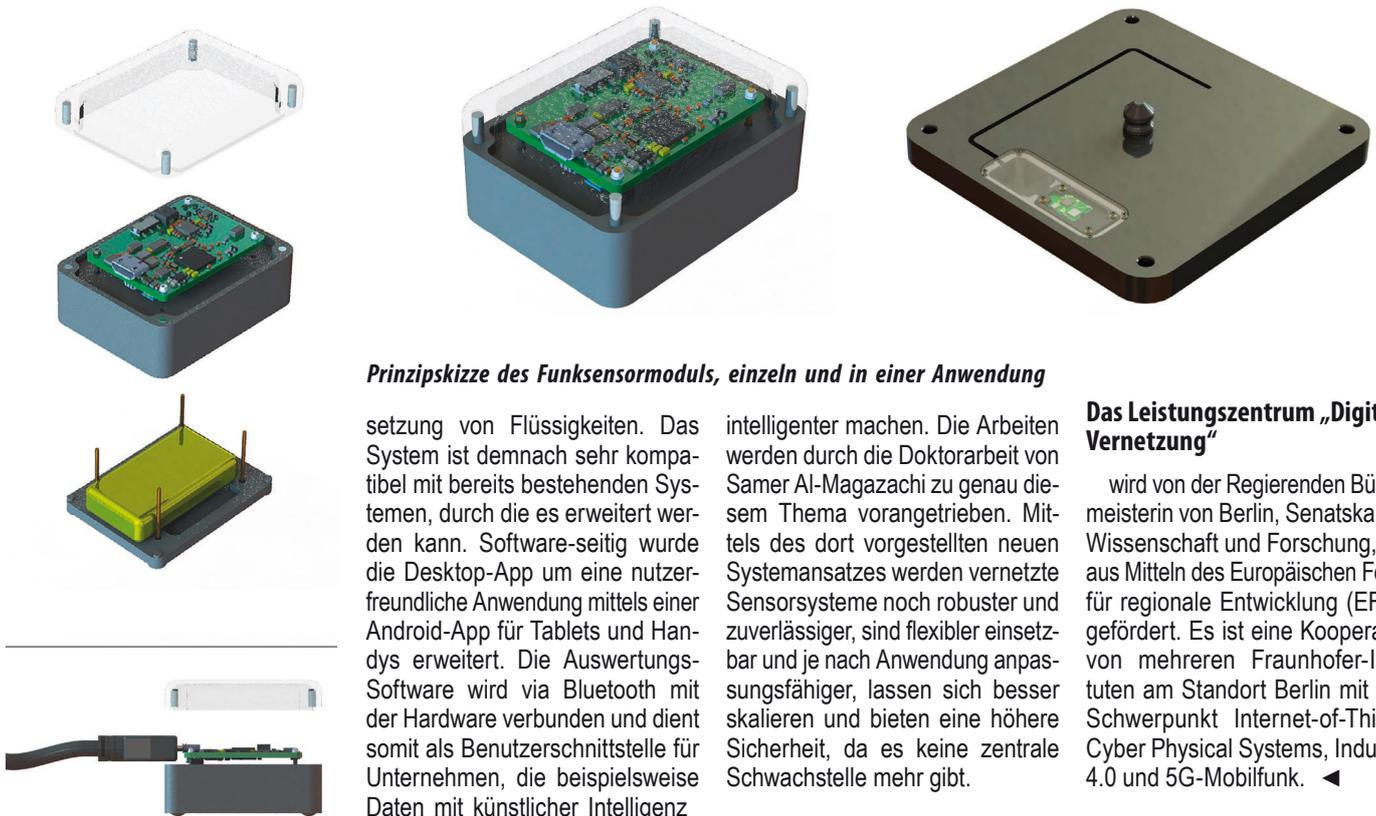
Prinzipskizze des Funksensormoduls, einzeln und in einer Anwendung
