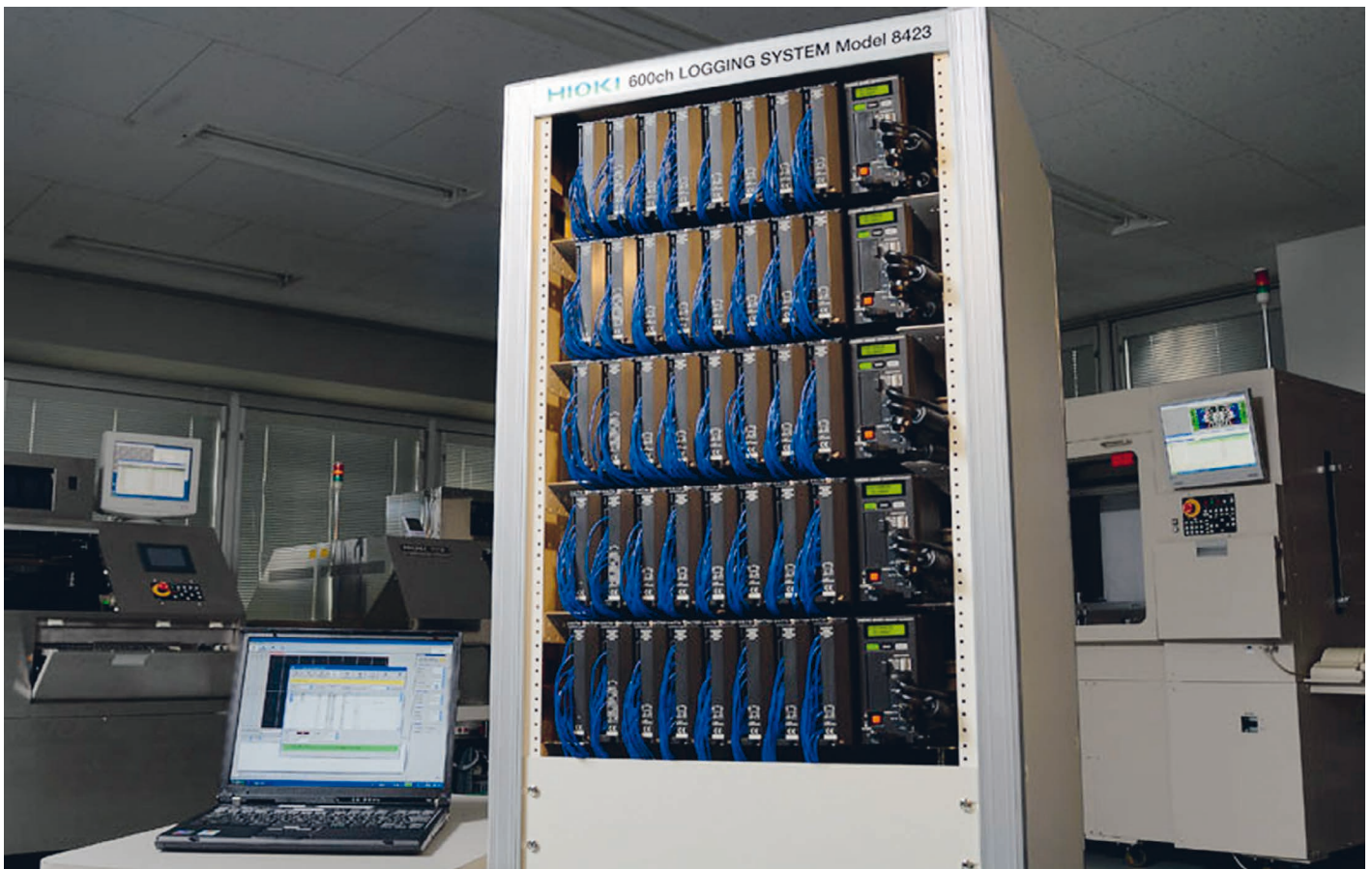
Bild 3: „Vollausbau“ - fünf kombinierte Hioki 8423-Systeme mit jeweils acht Modulen
