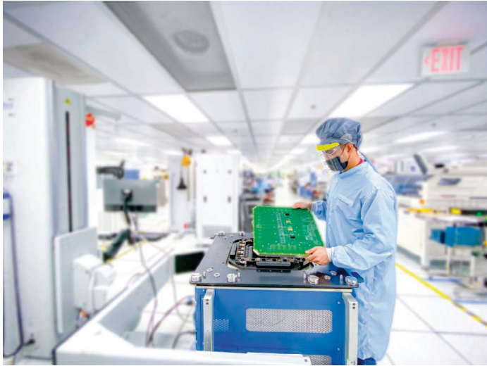
Bild 1: Bediener installiert ein Load-Board auf einem Tester zur Prüfung von digitalen SoCs
