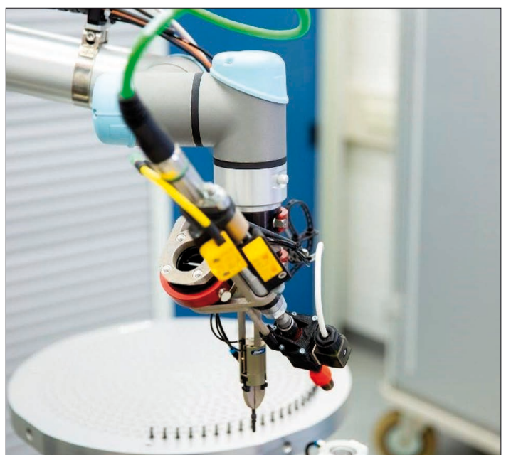
Ein Roboterarm entnimmt bei ArianeGroup per Greifaufsatz die Lötverbindung
