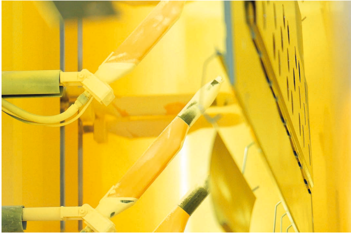
Pulverbeschichtung von Aluminiumteilen
