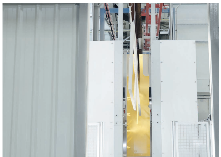
Bild 1: Messsysteme zur Inline-Schichtdickenkontrolle amortisieren sich oft schon nach Monaten, vor allem weil das Einhalten der optimalen Beschichtungsstärke tonnenweise Pulver im Jahr spart
