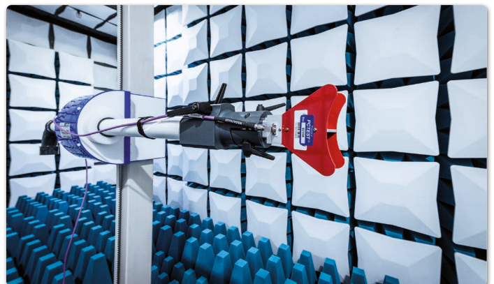
EMC-Test einer Baugruppe für 5G
