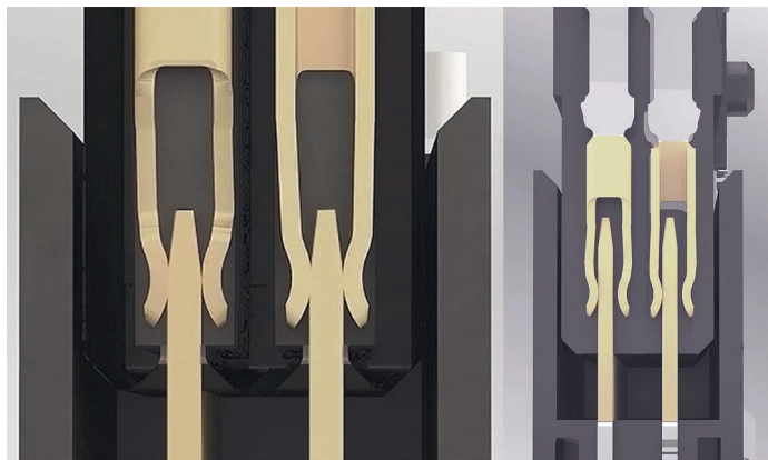
Bild 4: Schematische Darstellung: doppelseitiger Federkontakt des One27 ohne (links) und mit Schockeinwirkung (rechts)
