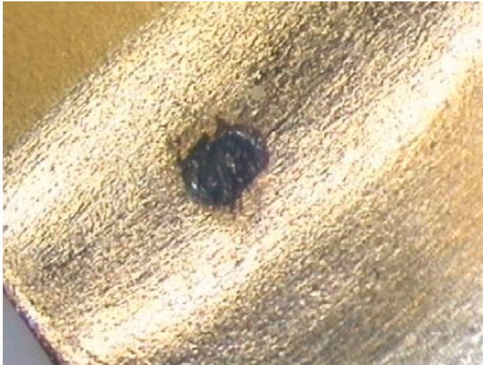
Bild 2: Abrieb und Korrosion der Kontaktoberfläche
