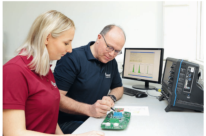
Während einer Schaltungsuntersuchung werden Schwingsicherheit, Frequenzgenauigkeit sowie die Leistung am Quarz analysiert
