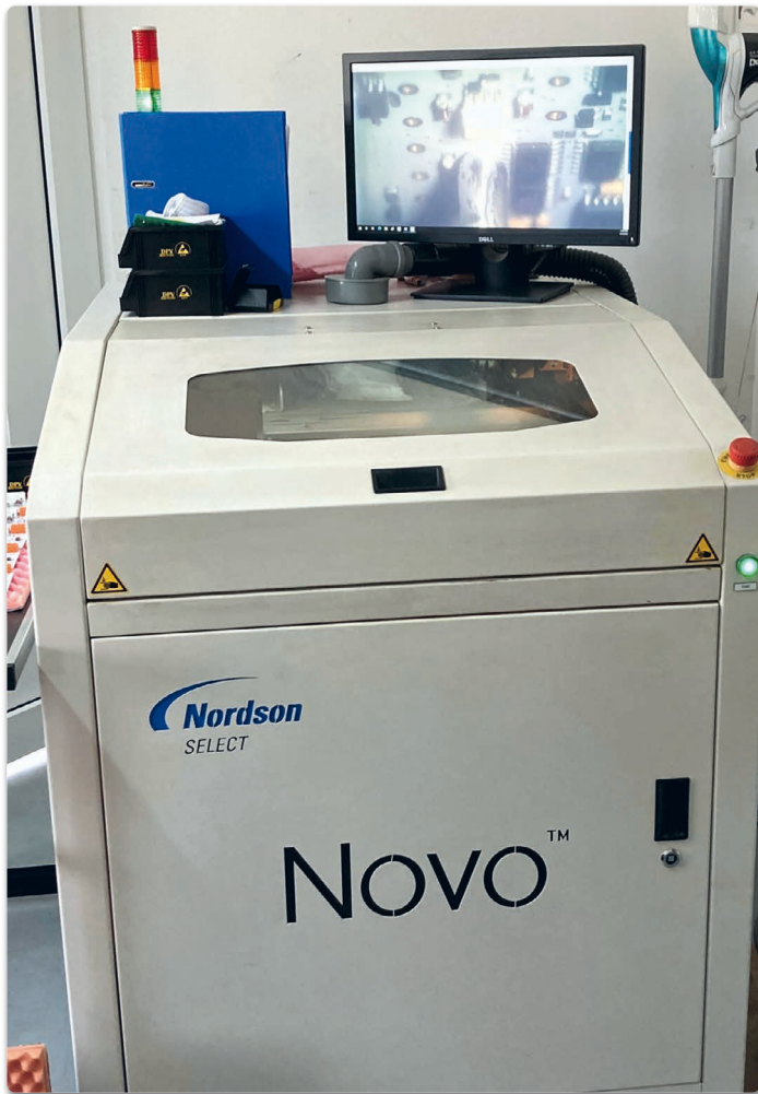
Die Selektivlötanlage Novo von Nordson Select im Einsatz bei Elektrotechnik Weber. Dank eingebautem Kamerasystem lässt sich jeder Lötvorgang im Detail auf dem Monitor verfolgen
