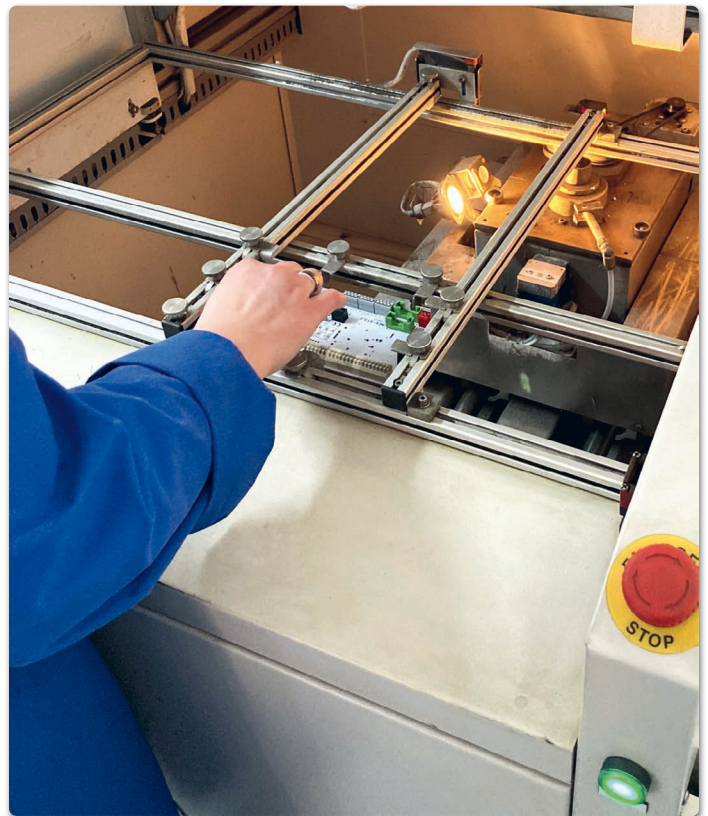
Bild 1: Eine Baugruppe mit zahlreichen Steckverbindern und anderen THT-Bauteilen wird eingelegt. Im Hintergrund erkennt man den Löttiegel sowie die Kamerabeleuchtung
