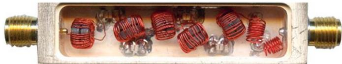
**Bild 5: Ausführung eines diskreten Bandpassfilters**
