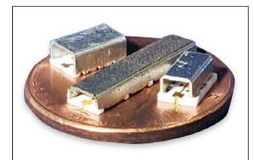
**Bild 10: Planare Filter**
