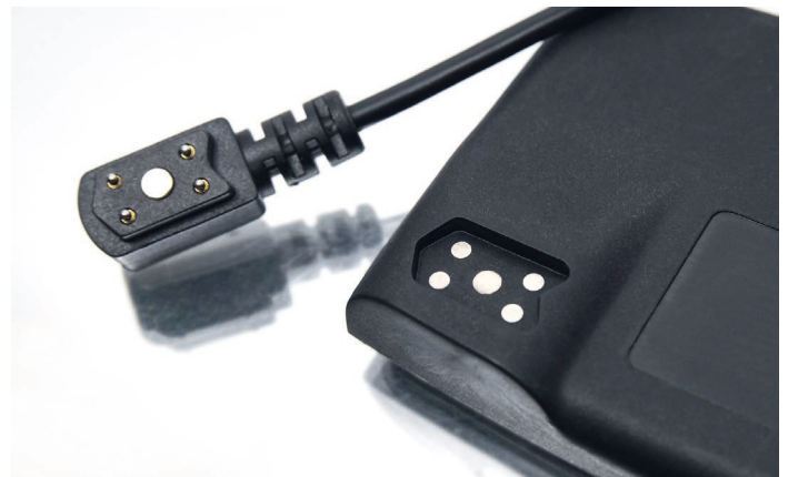
Bild 1: Integration der magnetischen Buchse im Gehäuse
