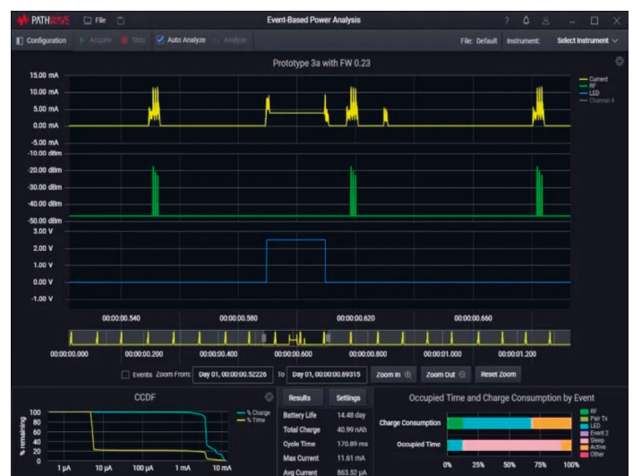
Bild 2: Die ereignisbasierte Leistungsanalysesoftware zeigt Strom-, HF-Leistungs- und LED-Versorgungsspannungswellenformen zusammen mit Diagrammen und Statistiken, die das Geräteverhalten beschreiben.
