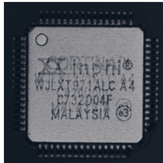
Analyse des Bauteils mit dem Ultraschallmikroskop. Es kommt eine weitere Laser-Markierung zum Vorschein – das Bauteil wurde manipuliert!
