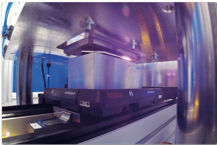
Das Laserschweißsystem EVO 3800 im Betrieb
