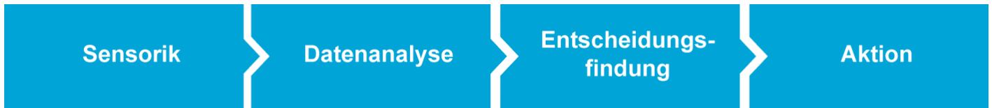
Bild 1: Die typischen Funktionsbausteine einer IoT-Anwendung ergeben eine vierstufige Prozesskette. Sensordaten werden durch eine KI-basierte Datenanalyse ausgewertet. Das Analyseergebnis dient zur Entscheidungsfindung und der jeweils erforderlichen Aktion. Diese Schrittkette lässt sich z. B. auf eine Condition-Monitoring-Anwendung in der Automatisierung übertragen. Sensoren erfassen den Maschinenzustand, Algorithmen bewerten fortlaufend die dabei anfallenden Daten. Die Ausgangsstufe „Aktion“ übermittelt die Entscheidung als Sollwert per IO-Link, Profinet oder CAN an eine Steuerung, um beispielsweise die Maschinengeschwindigkeit zu modulieren.
