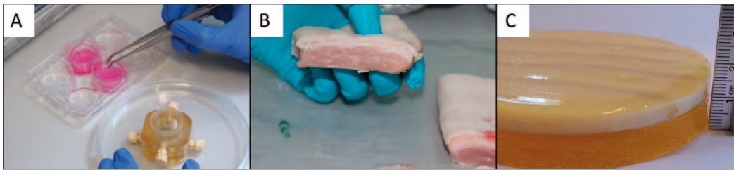
Bild 3: Verschiedene Gewebemodelle als Ersatz zu menschlicher Haut für die effiziente Validierung neuer Produkte (A: 3D-Hautmodelle gezüchtet aus humanen Zellen (in-vitro Modelle), B: Schweinehaut (ex-vivo Modelle), C: technische Modelle)
